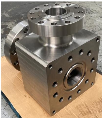
M&M Jomar se ha convertido en especialista en el *mecanizado de válvulas* de diferentes tipos y aplicaciones para los sectores industriales como petroquímicas, papeleras, maquinaria agrícola, utillaje industrial y nuclear y materiales como el inconel, titanio y acero al carbono.
